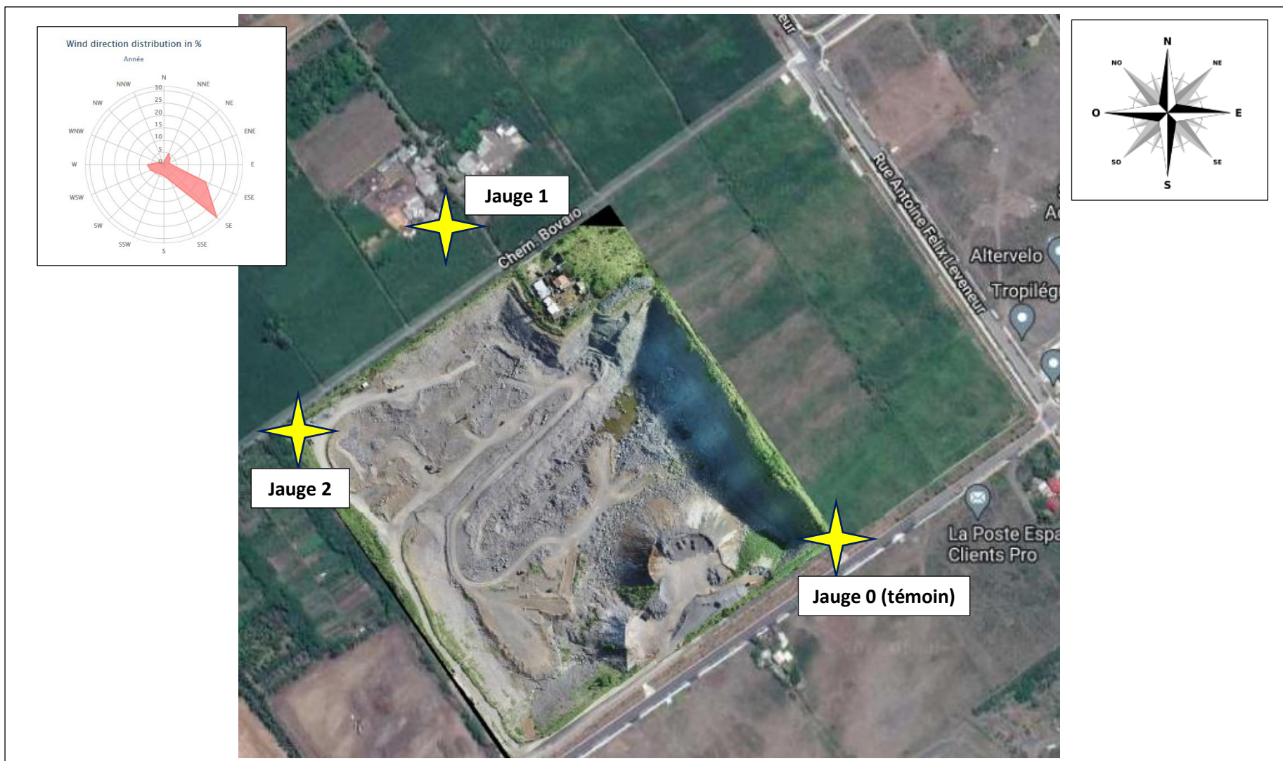
Implantation des Jauges de retombées de poussières sur la carrière de PIERREFONDS.
