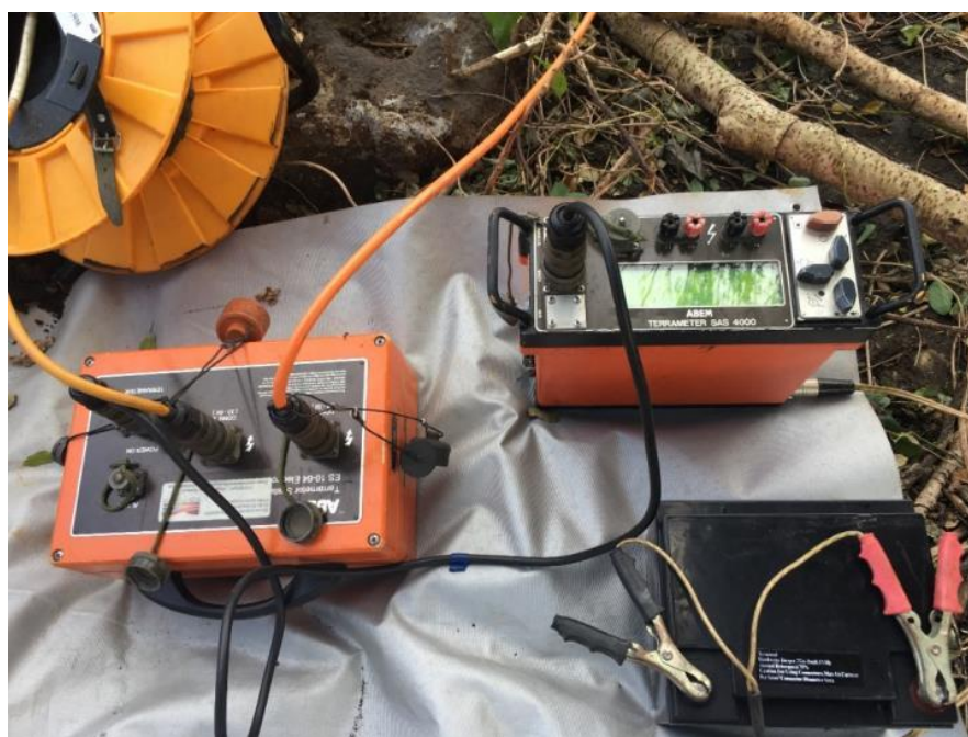
Figure 6 : Terrameter ABEM et multiplexeur ABEM lors de l'acquisition. (Stratagem974).
